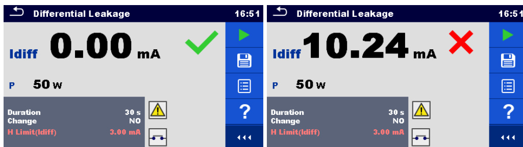
Abbildung 6.39: Beispiele für Ergebnisse der Differenzableitstrom Messung
