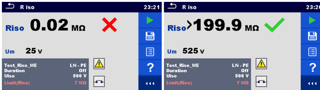
Abbildung 6.88: Beispiele für Ergebnisse der Isolationswiderstandsmessung (medizinische Geräte)
