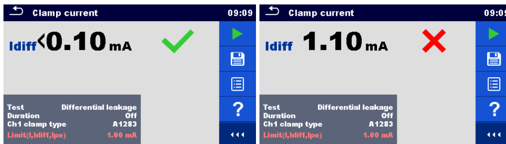
Abbildung 6.74: Beispiele für Ergebnisse der Messung des Zangenstroms
