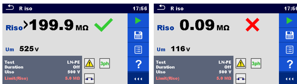
Abbildung 6.76: Beispiele für Ergebnisse der Isolationswiderstandsmessung (Schweißgeräte)
